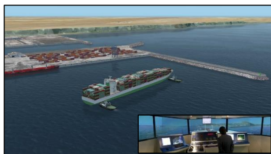
Figura 8. Simulação da acostagem de porta-contentores com apoio de rebocadores (Siport21).
