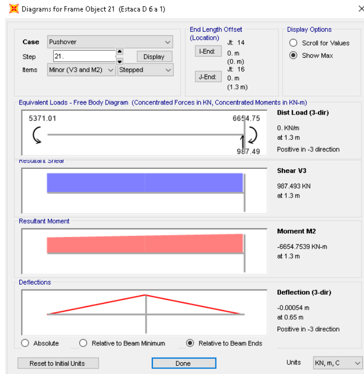
Figura 9. Diagramas de esforços na estaca rotulada para deslocamentos alvo de 0,16 m
