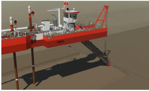
a) Dragagem de corte, sucção e repulsão (IHC Beaver B50)
