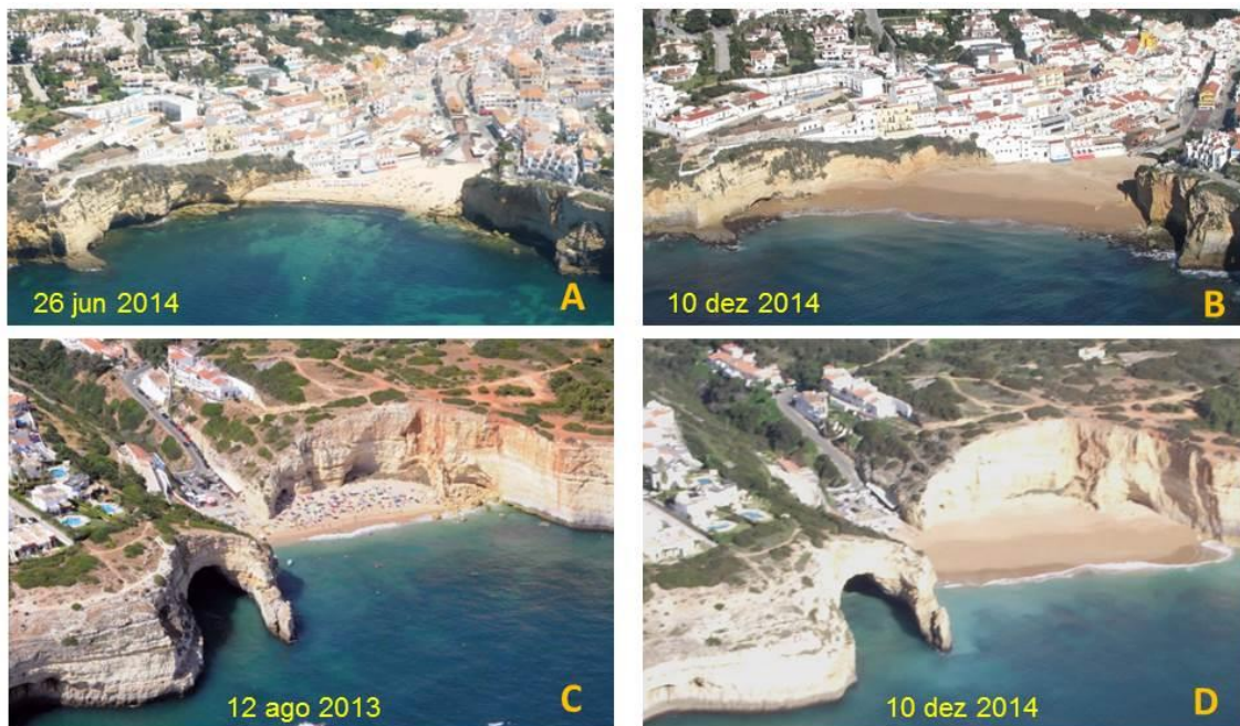
Figura 5. Alterações nas praias do Carvoeiro e Benagil antes (A, C) (26 junho 2013 e 12 agosto 2013) e após a alimentação artificial (B, D) (10 dezembro 2014).
