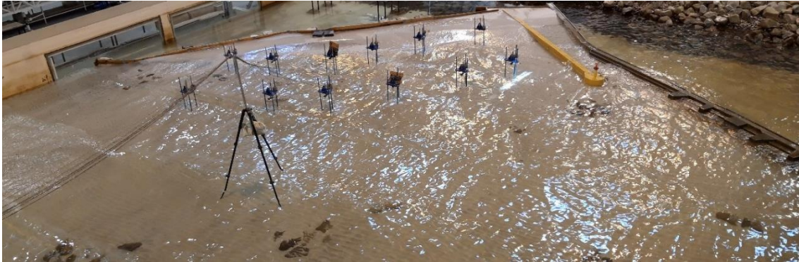
Figura 8 – Implantação do modelo físico no tanque de ondas – direção WNW. Localização das sondas de níveis hidrodinâmicos.
