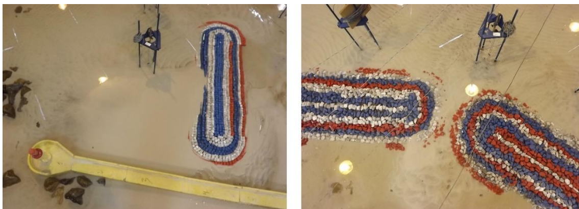
Figura 11 – Assoreamento na periferia dos quebramares de taludes para o nível de água de +0.5 m ZH (BMAV).
