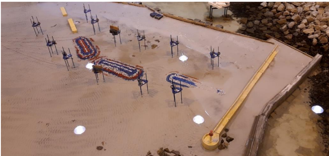
Figura 10 – Modelo físico na fase inicial dos testes para o nível de água +3.50 m ZH (PMAV).
