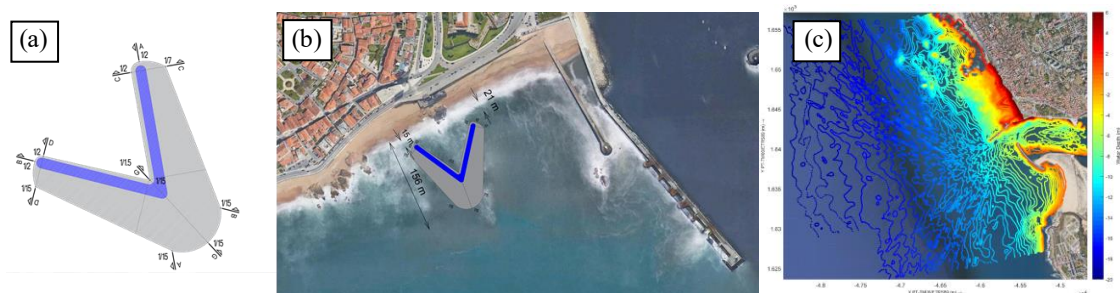
Figura 1. Configuração do recife artificial (a), a sua implantação na praia do Carneiro (b) e (c) batimetria da área de estudo.
