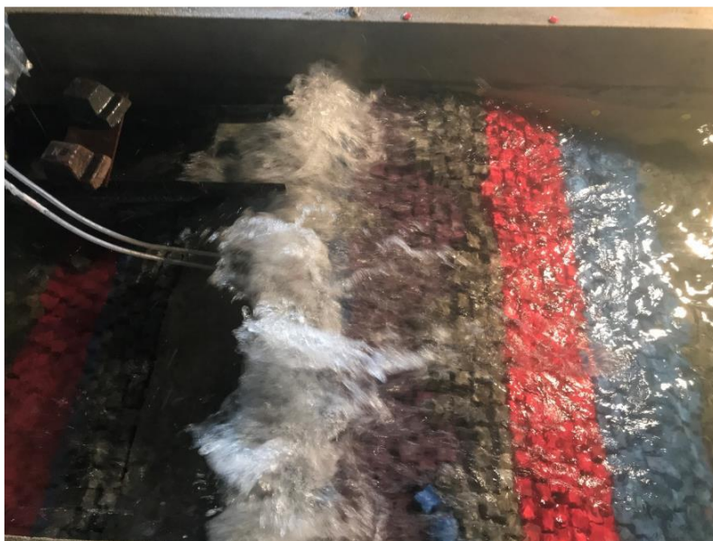
Figura 7 - Ensaio de galgamento. Aspeto dos galgamentos verificados (LNEC)
