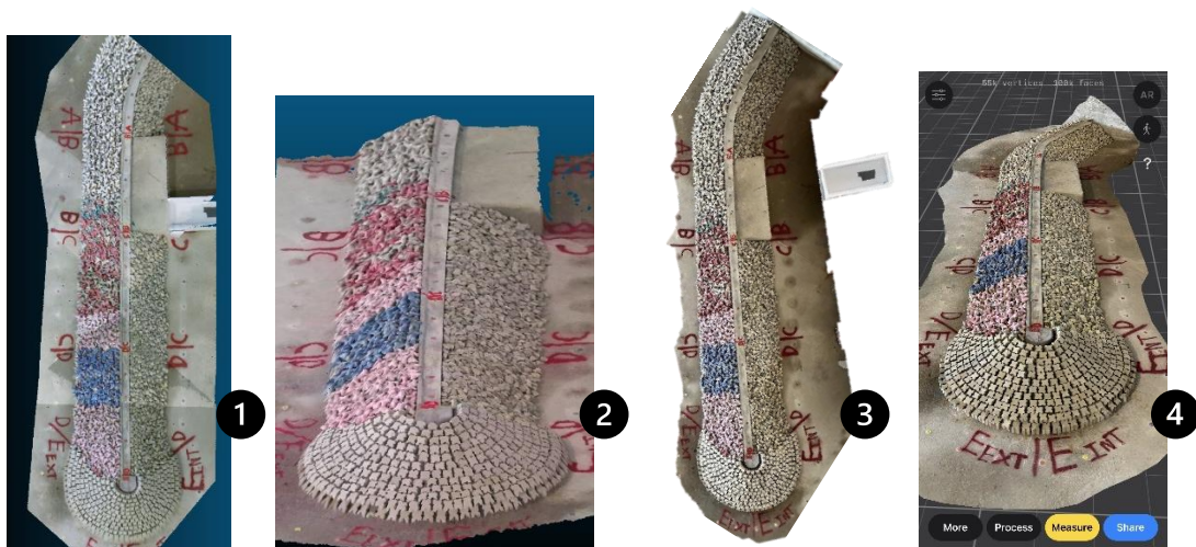
Figura 3. Nuvens de pontos obtidas com as 4 técnicas (Kinect, Azure, Fotogrametria e LiDAR)
