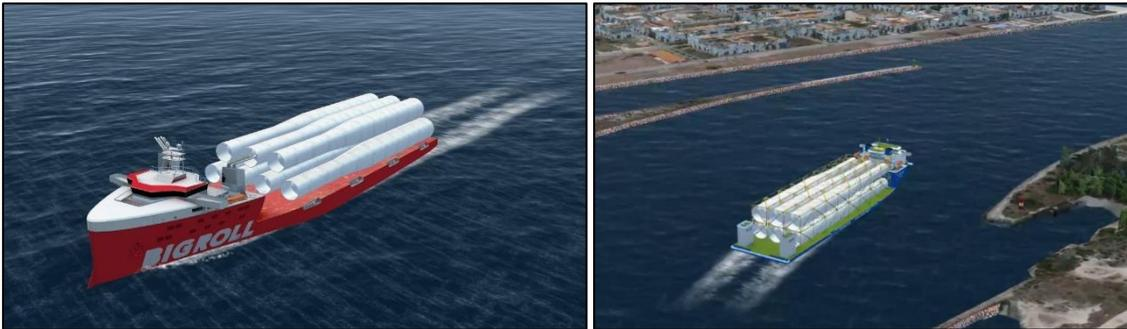
Figura 2. Exemplo de 2 embarcações *heavy lift* em manobras realizadas em simulador de manobras em tempo real.
