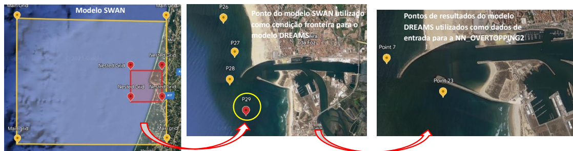
Figura 4. Fluxograma de modelos utilizados para a estimativa do caudal médio de galgamento para o Porto da Figueira da Foz.
