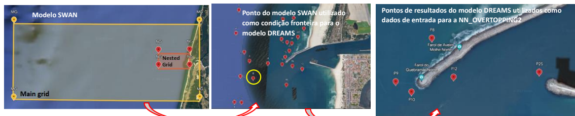
Figura 2. Fluxograma de modelos utilizados para a estimativa do caudal médio de galgamento para o Porto de Aveiro.
