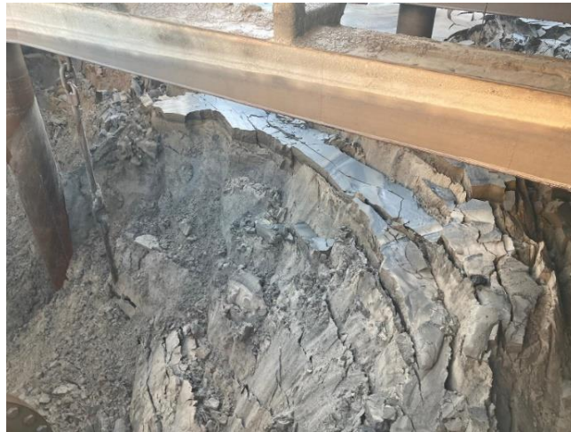
Figura 14 – Areia a bordo do porão da TSHD Meuse River posteriormente imersa na Área de Imersão 3 pelo método de Rainbowing .
