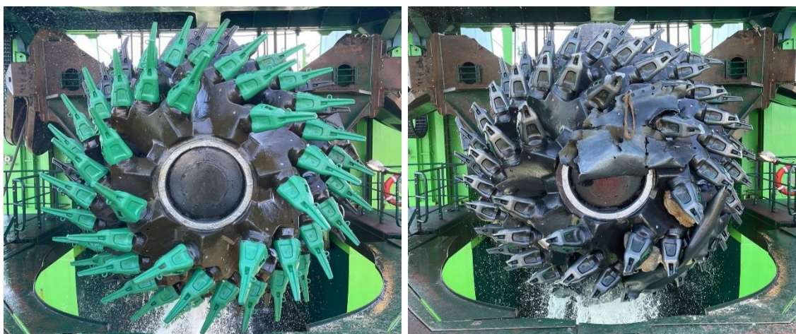
Figura 11. CH da CSD Spartacus equipada com um set completo de dentes de corte novos, à esquerda, e à direita, a mesma CH após a dragagem de rocha dura no Porto de Leixões.
